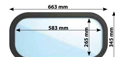
Abgerundete Ecken (r = 100 mm), hoher Isolierungswert
